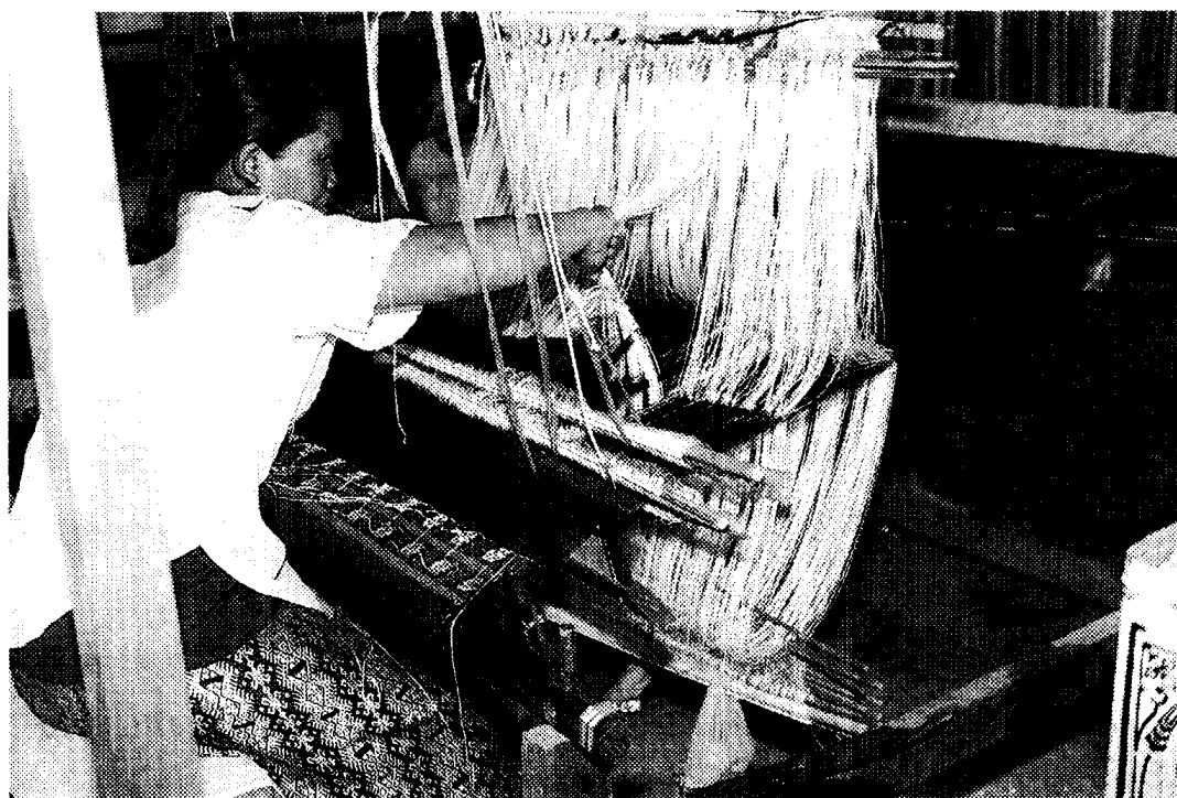
図6 紋綜統を持ち上げながら開口保持具を挿入する
