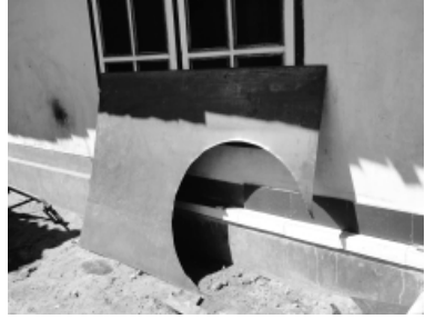
(写真6) 鉄板からゴング面を 切り抜いたもの
