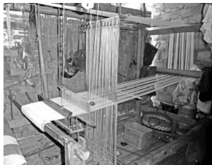
写真1 写真中央、経糸に対して垂直に交わっている糸の束が垂直紋綜統
